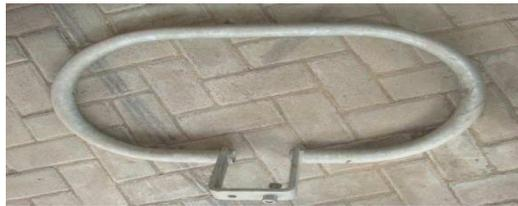
Gambar 2.39 *Arcing horn* sisi penghantar
