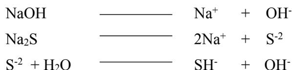
Pada proses ini bahan-bahan kimia dan cairan pemasak sebagai penetrasi ke dinding-dinding serat dan melarutkan lignin adalah ion OH<sup>-</sup> dan HS<sup>-</sup>.
