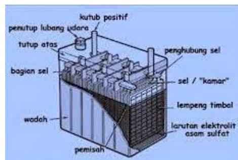
**Gambar 2.2** Struktur Baterai Sekunder
