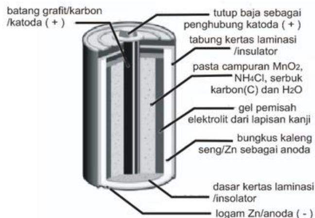
**Gambar 2.1** Struktur Baterai Primer
