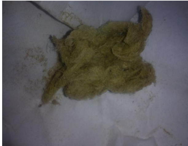
Gambar 28. Selulosa setelah dikeringkan
