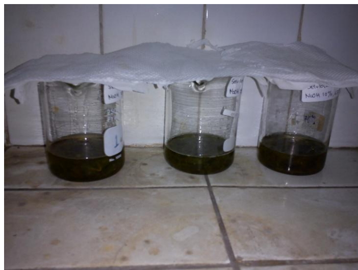
Gambar 24. Selulosa didiamkan Selama 30 menit
