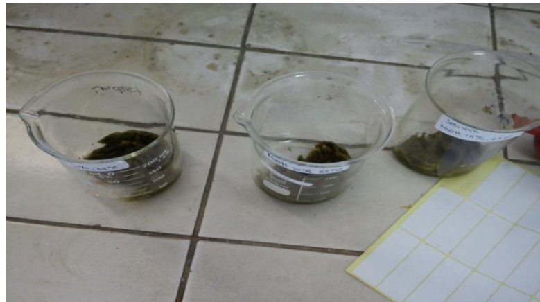
Gambar 23. Penambahan 15 ml NaOH 17,5%
