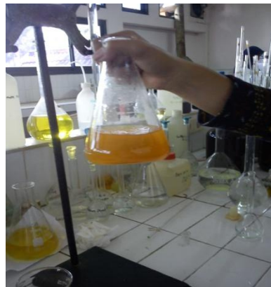
Gambar 34. Proses Titrasi dengan Larutan \text{Na}_2\text{S}_2\text{O}_3
