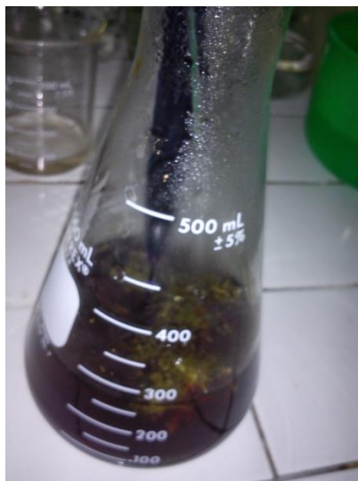
Gambar 31. Penambahan 25 ml Larutan \text{KMnO}_4 0,1N dan 25 ml \text{H}_2\text{SO}_4 4N
