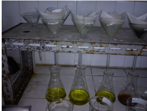
Gambar 25. Pencucian Selulosa dengan menggunakan Aquadest
