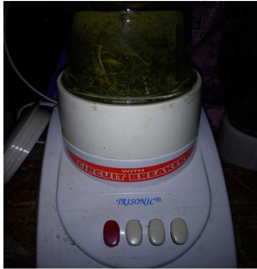
Gambar 13. Penghalusan Sansevieria dengan Menggunakan Chooper
