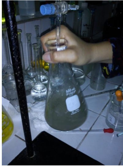
Gambar 36. Proses Titrasi dengan Larutan \text{Na}_2\text{S}_2\text{O}_3 hingga Bening
