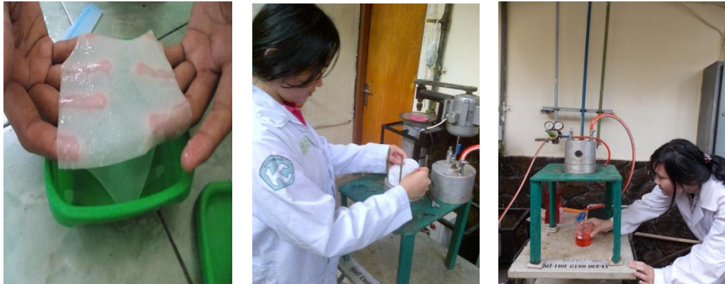
Membran kitosan-PVA Pemasangan Membran Pengolahan limbah dengan membran
