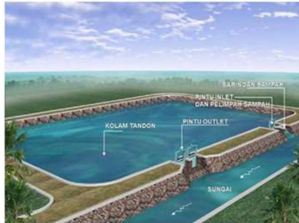
Gambar 2.1 Kolam Retensi Tipe di Samping
