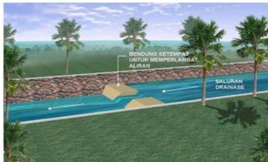
Gambar 2.3 Kolam retensi tipe *storage* memanjang
