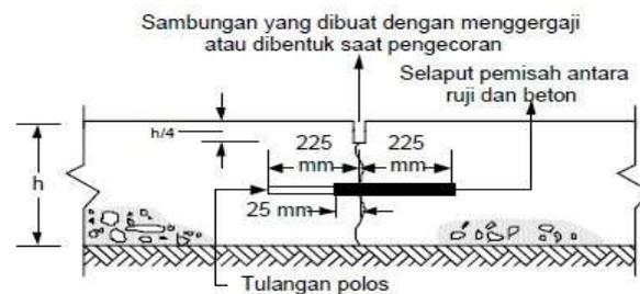
Gambar 2.35 Sambungan susut melintang dengan ruji
