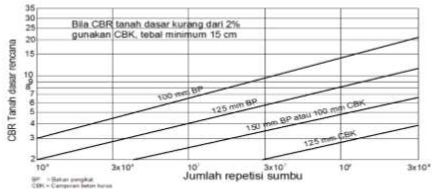
Gambar 2.30 Tebal Pondasi Bawah Minimum untuk Beton Semen
