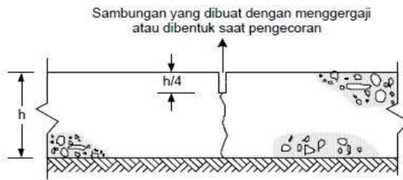
Gambar 2.34 Sambungan susut melintang tanpa ruji
