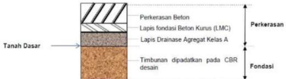
Gambar 2.28 Gambar tipikal perkerasan kaku pada timbunan
