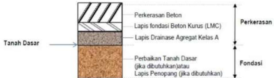
Gambar 2.27 Gambar tipikal perkerasan kaku pada permukaan tanah asli
