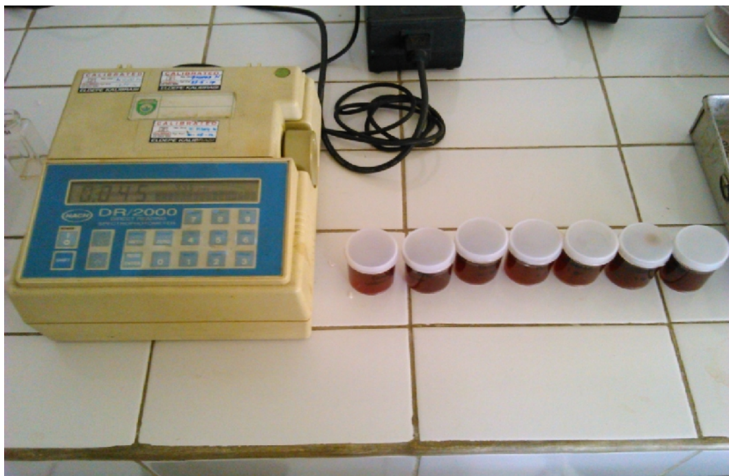
Pengukuran absorbansi pada kain yang telah difiksasi pada alat spektrofotometri dengan panjang gelombang 445 nm
