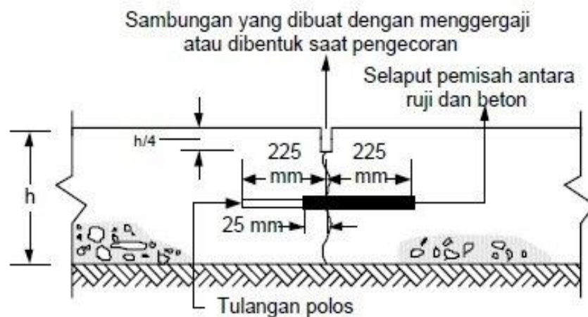
Gambar 2.35 Sambungan Susut Melintang dengan Ruji
