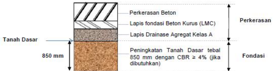
Gambar 2.29 Tipikal perkerasan kaku pada galian
