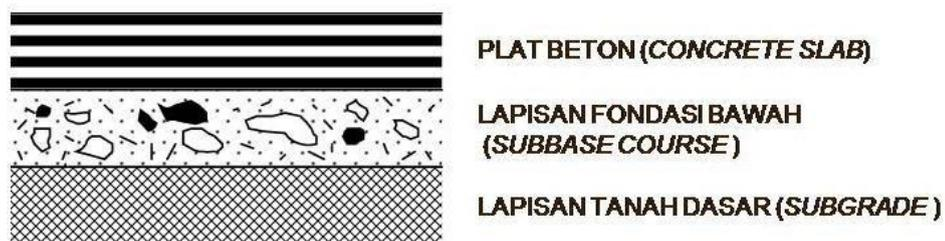
**Gambar 2.16** Susunan Lapisan Perkerasan Kaku
