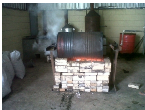
Proses pengarangan di tungku pengarangan (karbonisasi)
