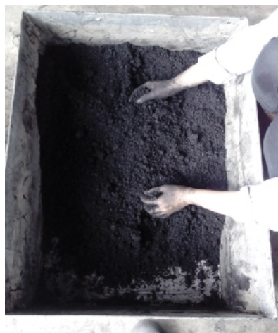
Campuran arang ampas tebu, arang tempurung kelapa, dan perekat
