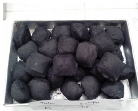
Biobriket dengan rasio ampas tebu dan tempurung kelapa 50:50 yang telah dicetak
