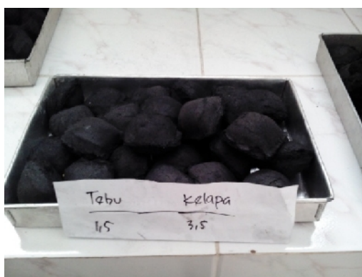
Biobriket dengan rasio ampas tebu dan tempurung kelapa 70:30 yang telah dicetak
