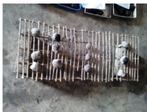
Biobriket pada saat uji lama nyala
