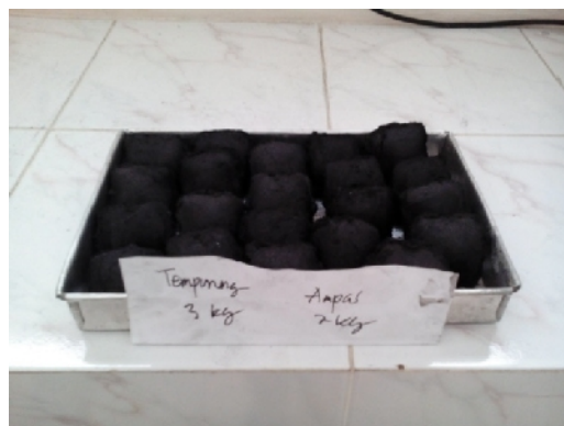
Biobriket dengan rasio ampas tebu dan tempurung kelapa 60:40 yang telah dicetak
