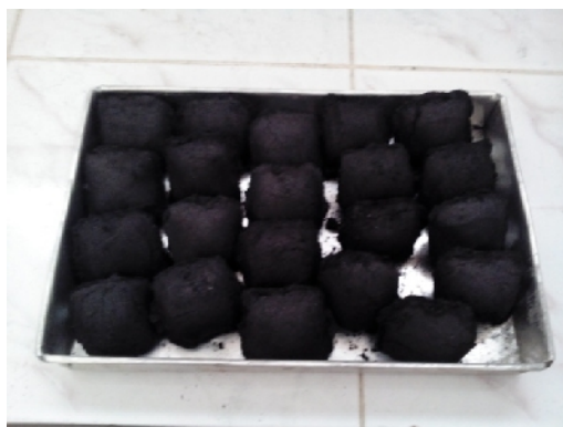
Biobriket dengan rasio ampas tebu dan tempurung kelapa 40:60 yang telah dicetak
