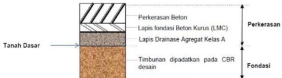
Gambar 2.26 Gambar tipikal perkerasan kaku pada timbunan
