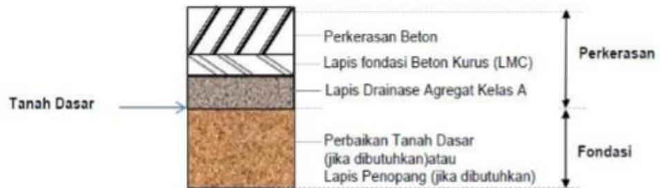
Gambar 2.25 Gambar tipikal perkerasan kaku pada permukaan tanah asli
