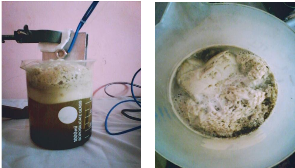
Gambar 18. Gumpalan Busa Lindi Sampah Setelah Proses Elektrokoagulasi
