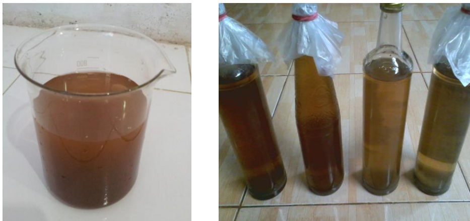
Gambar 19. Hasil Pengolahan Lindi Sampah dengan Proses Elektrokoagulasi
