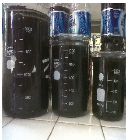
Gambar 16. Poses Perendaman karbon dengan aktivator HCl 0.1 N dan Proses Pencucian dan penyaringan karbon aktif
