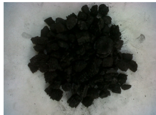
Gambar 13. Karbon Ampas Tebu dan Tongkol Jagung Setelah Proses Karbonisasi
