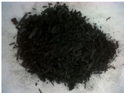
Gambar 13. Karbon Ampas Tebu dan Tongkol Jagung Setelah Proses Karbonisasi
