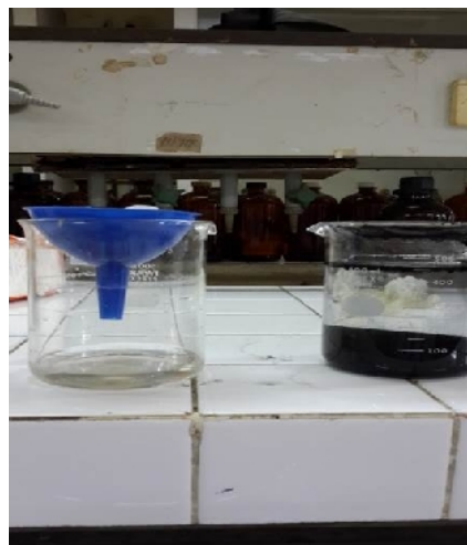
Gambar 16. Poses Perendaman karbon dengan aktivator HCl 0.1 N dan Proses Pencucian dan penyaringan karbon aktif
