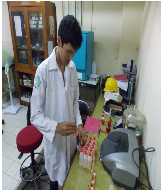
Pembuatan Larutan standar Spektrofotometer UV-Vis
