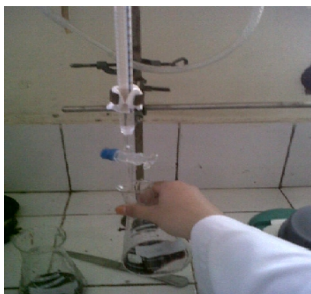
Gambar L3.20. Titrasi kadar Ca
