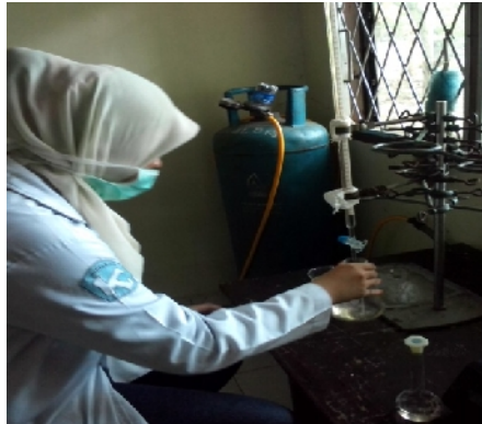
Gambar L3.12. Titrasi larutan kjeldahl
