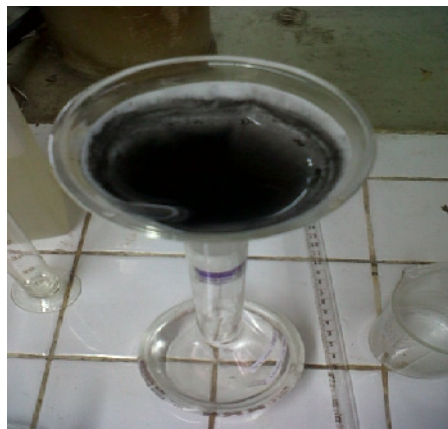
Gambar L3.19. Filtrat abu di saring
