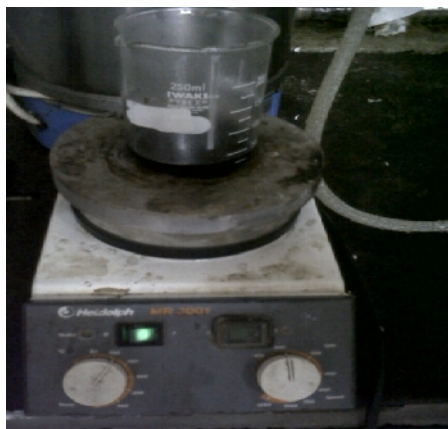
Gambar L3.18 Abu dipanaskan dengan HCl
