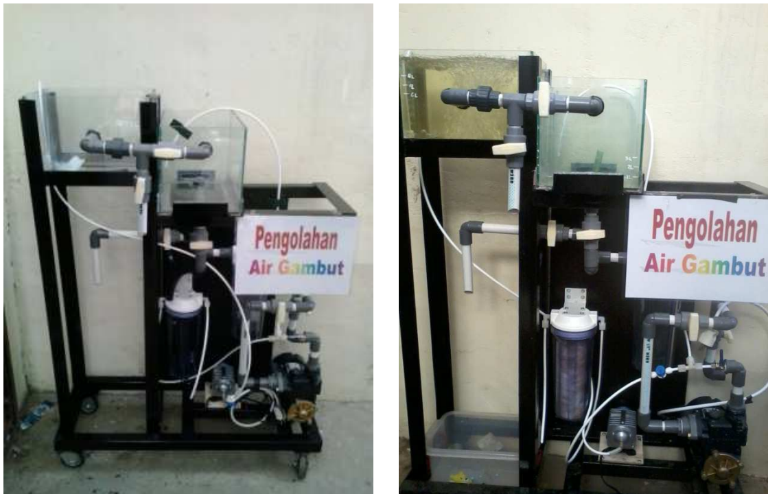
Gambar 1. Alat Pengolahan Air Gambut dengan Menggunakan Proses Aerasi, Koagulasi, dan Filtrasi
