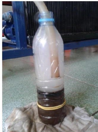
Gambar 10. Penampungan bahan bakar cair hasil proses perengkahan
