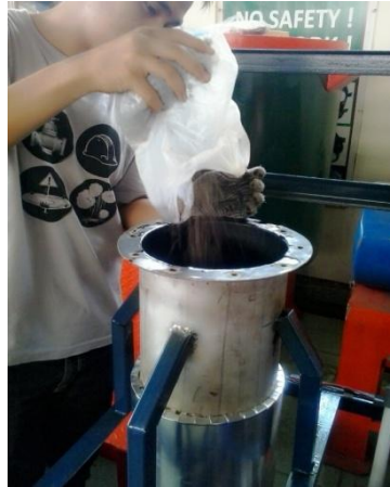
Gambar 9. Proses memasukkan bahan kedalam reaktor
