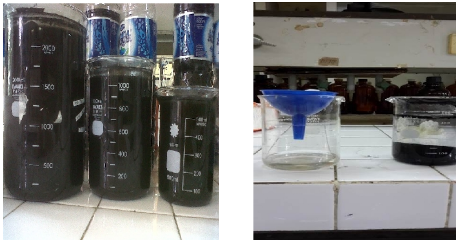
Gambar 12. Poses Perendaman karbon dengan aktivator H_3PO_4 2 M dan Proses Pencucian dan penyaringan karbon aktif
