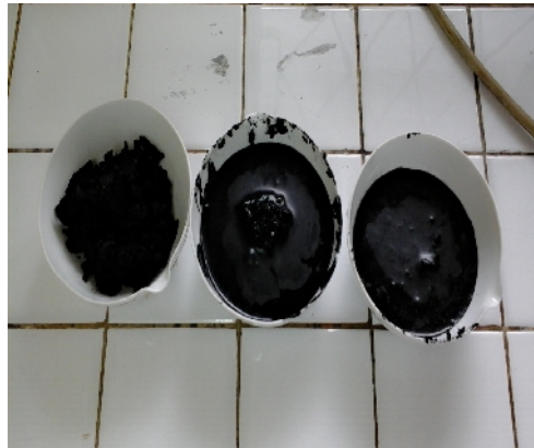
Gambar 13. Pengeringan Karbon Aktif setelah di Aktivasi
