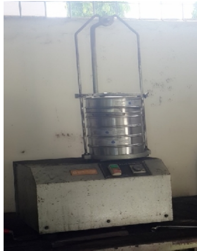
Gambar 10. Pengayakan Karbon dengan Ayakan Tyle
