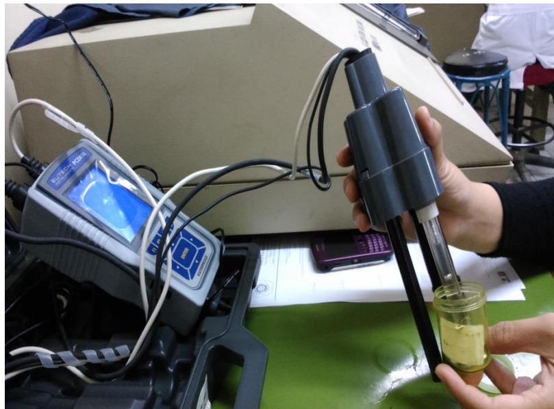
Pengecekan pH ekstrak klorofil menggunakan pH-meter
