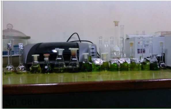
Pengecekan Absorbansi Ekstrak Klorofil menggunakan spektrofotometer UV/vis
