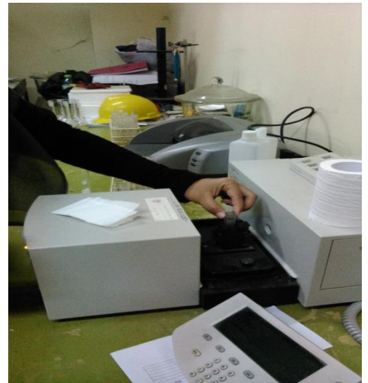
Pengecekan Absorbansi Ekstrak Klorofil menggunakan spektrofotometer UV/vis
