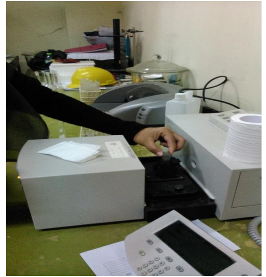
Pengecekan Absorbansi Ekstrak Klorofil menggunakan spektrofotometer UV/vis
