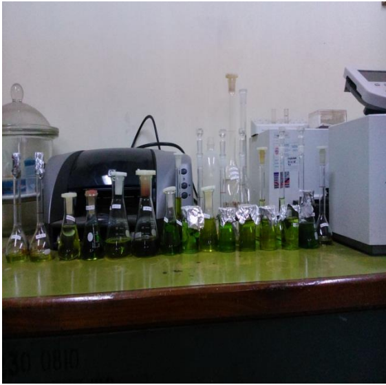
Pengecekan Absorbansi Ekstrak Klorofil menggunakan spektrofotometer UV/vis
