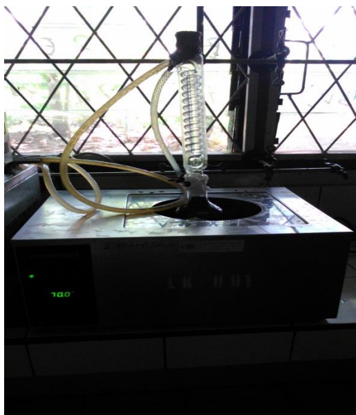
Ekstraksi dengan metode refluks
