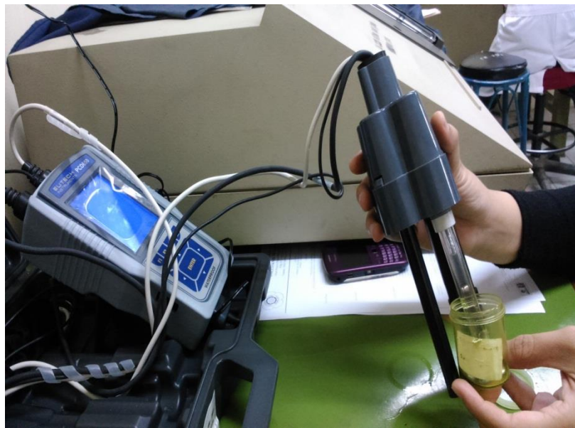
Pengecekan pH ekstrak klorofil menggunakan pH-meter
