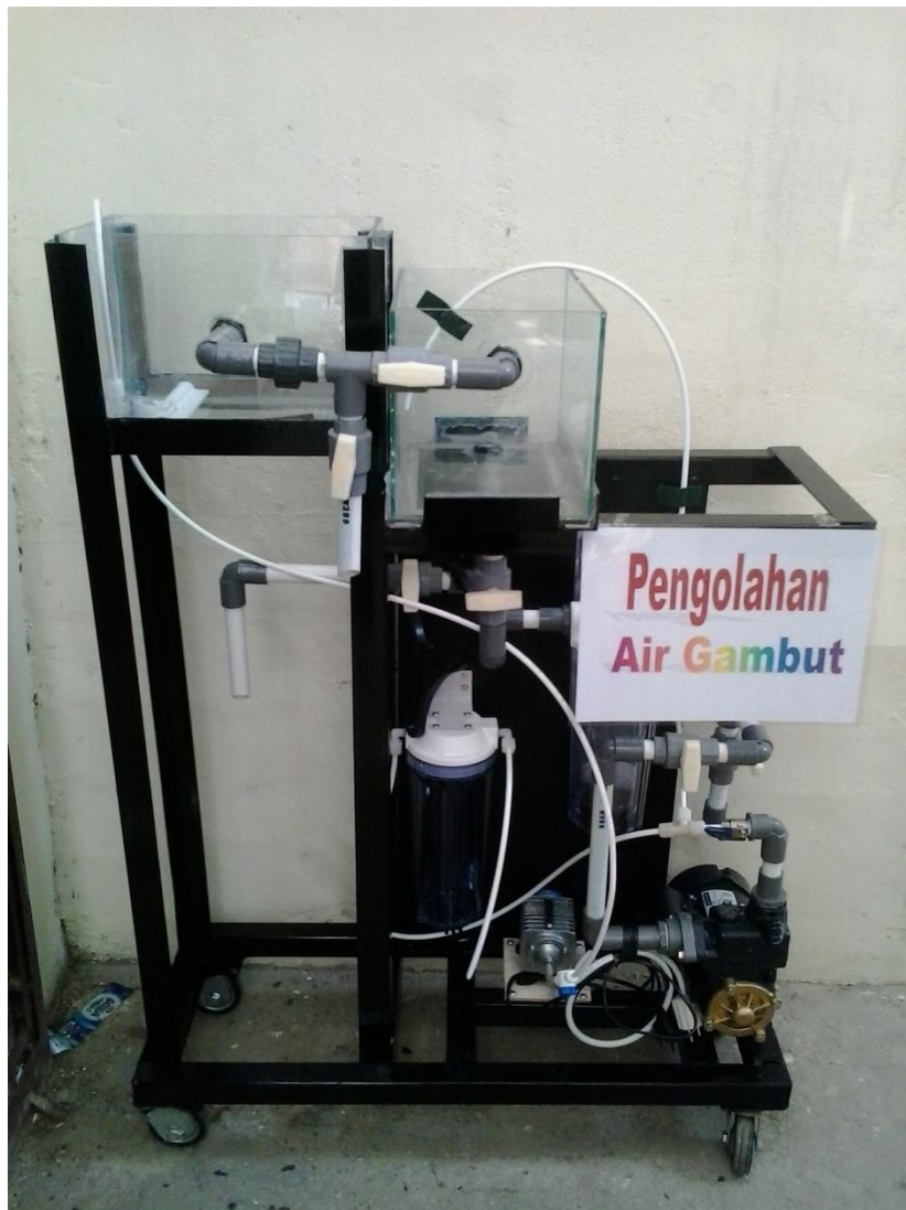
Gambar 5. Unit Pengolahan Air Gambut
