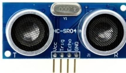
**Gambar 2. 13** Sensor Ultrasonik
