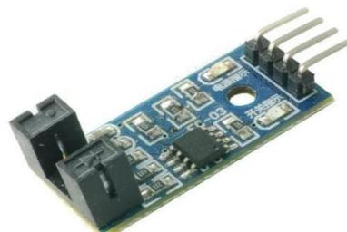
**Gambar 2. 14** Sensor Kecepatan
