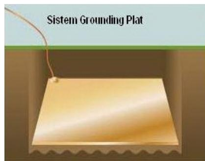
**Gambar 2.8** Elektroda Plat
