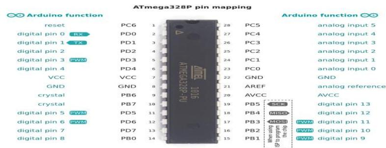
Gambar.2.9. Mikrokontoler Atmega328P
