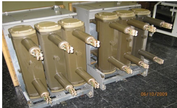
Gambar 2.10 PMT 20kV Media Pemadam Busur Api SF6
