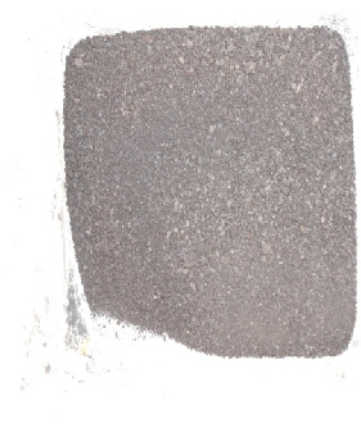
Batubara setelah dihaluskam
