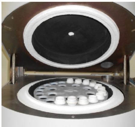
Memasukkan crusible ke dalam alat TGA
