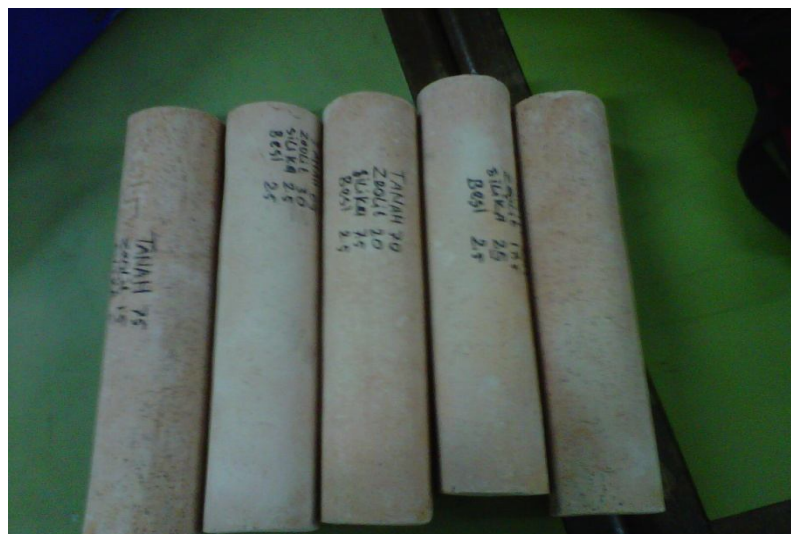
Gambar 5. Membran Keramik yang telah jadi
