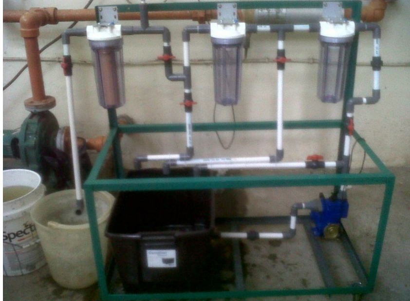
Gambar 6. Rangkaian alat Membran Keramik
