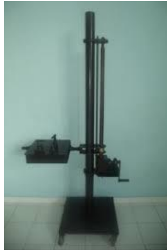
Gambar 2.2 Meja Las Adjustable Sumber: (Lit.4)
