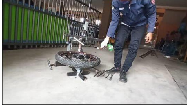
Gambar 5.6 Proses Pembersihan Vleg (Sumber; Dokumentasi)
