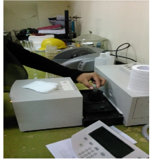
Pengecekan Absorbansi Ekstrak Klorofil menggunakan spektrofotometer UV/vis
