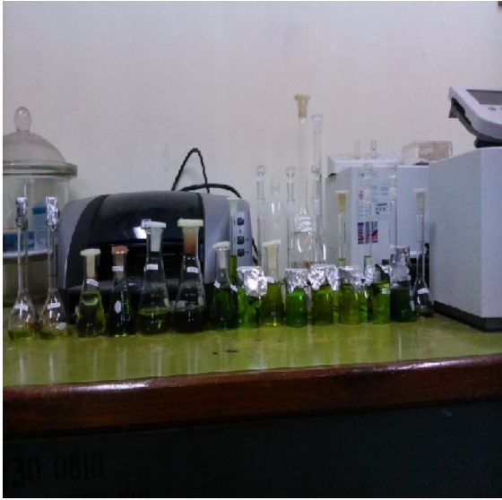
Pengecekan Absorbansi Ekstrak Klorofil menggunakan spektrofotometer UV/vis
