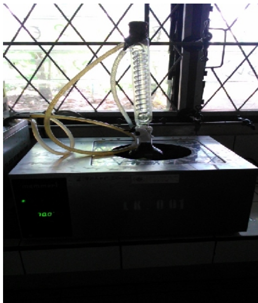
Ekstraksi dengan metode refluks
