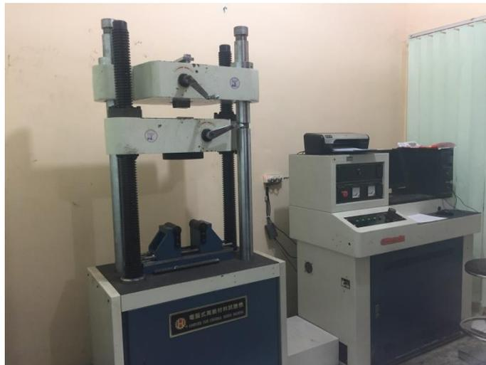
Gambar 2.18 Mesin Uji Tarik
