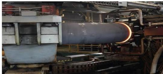
**Gambar 2.4 Bending Induksi Panas**
