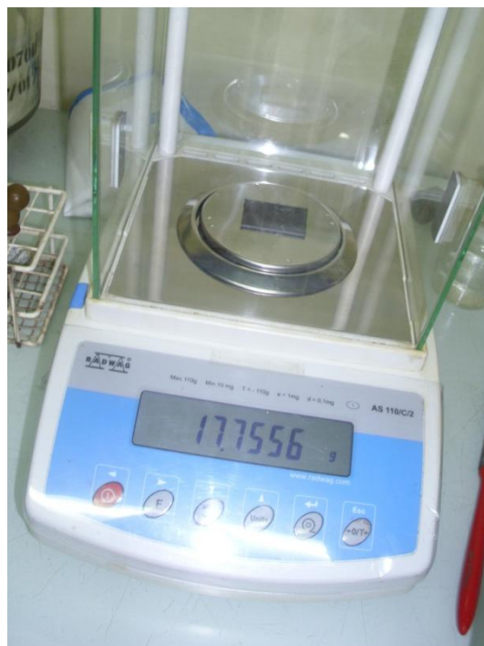
Penimbangan Logam Baja Setelah Perendaman di media Korosi Setiap 1 Minggu
