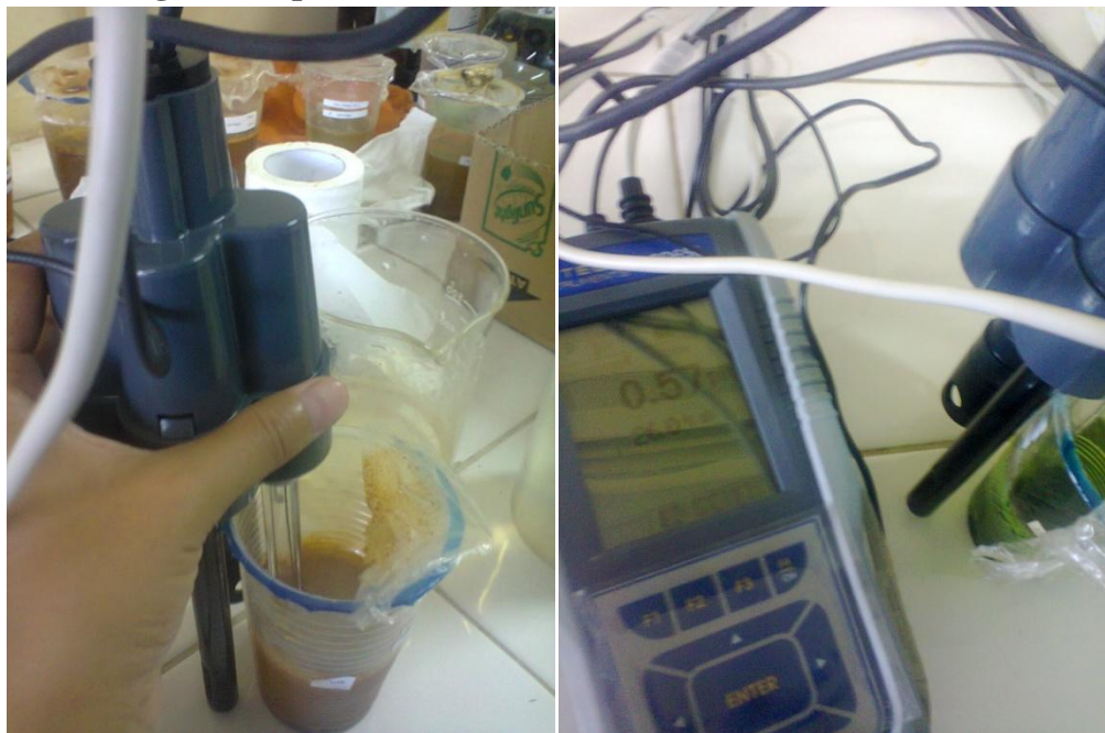
Pengukuran pH Media Korosi dengan Penambahan Bioinhibitor maupun Tanpa Penambahan.
