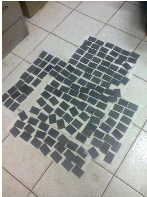
Logam Baja yang Telah Dibersihkan
