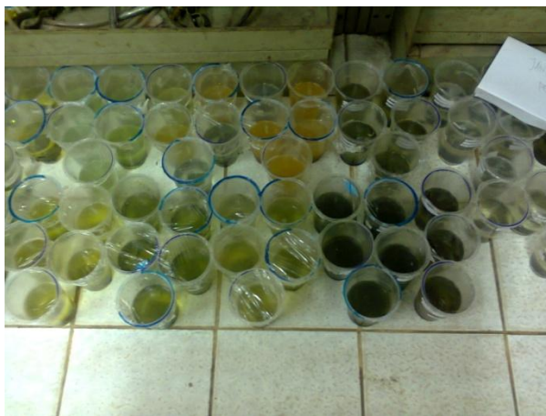
Perendaman Logam Baja pada HCl sebagai Media Korosi
