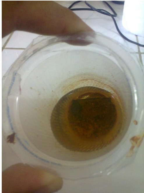
Tampak Logam Baja Telah Mengalami Proses Korosi
