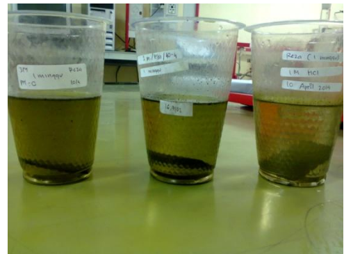
Perendaman Logam Baja pada HCl sebagai Media Korosi
