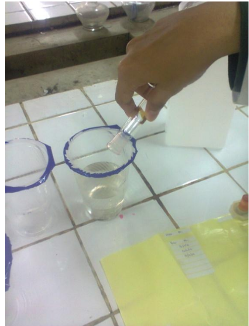
Pembuatan Larutan HCl sebagai Media Korosi
