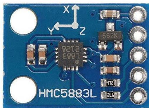
**Gambar 2. 6 Sensor Kompas HMC5883L**
