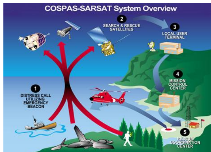
Gambar 2. 4 Sistem Kerja Satelit (Almuhblog, 2015)
